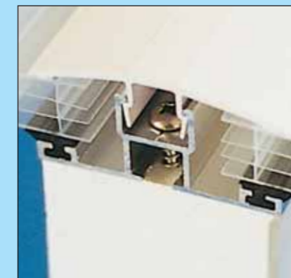
Samleprofil med gummilæber og PVC-dækliste med 2 bløde "læber" i hver side.
